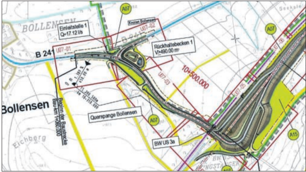
Planskizze der Querspange: So wie auf diesem Plan der Straßenbaubehörde soll die Abfahrt am Güldenberg bei Bollensen gebaut werden. Dafür sind immense Erdbewegungen vor allem südlich der lila eingezeichneten Bahnlinie (rechts im Bild) nötig. Das Bauwerk ähnelt der aktuellen Abfahrt an der Bollertsmühle bei Volpriehausen. Skizze: Straßenbauamt Gandersheim/nh
